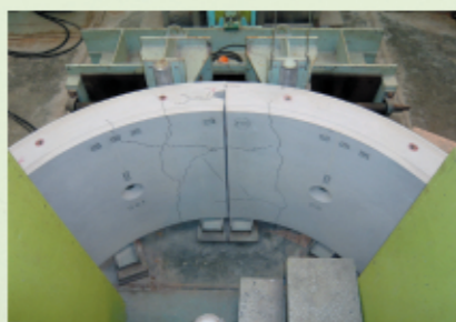
継手曲げ試験状況
